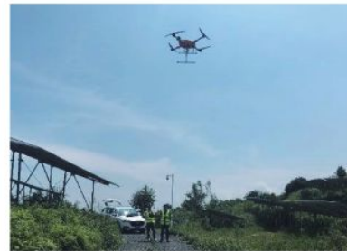
Prueba de imagen térmica infrarroja UAV
